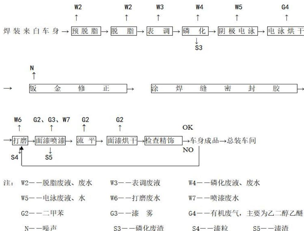
图 2-6 涂装工艺流程及主要产污环节图
